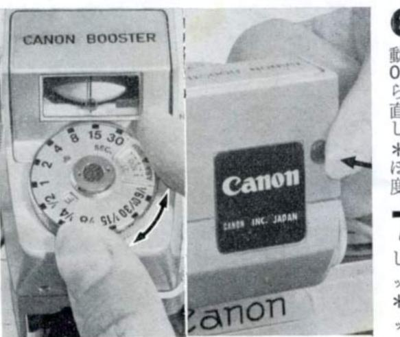
6 ブースタースイッチを ON にセットしますと、指針は被写体の明るさに応じて移動しますのでメーターダイアルを回し、指針を O 点に合わせます. さらに指針は微動しますから、再びメーターダイアルを回し O 点に合わせ直します. 被写体条件の悪い場合には数度繰返し調節してください.
